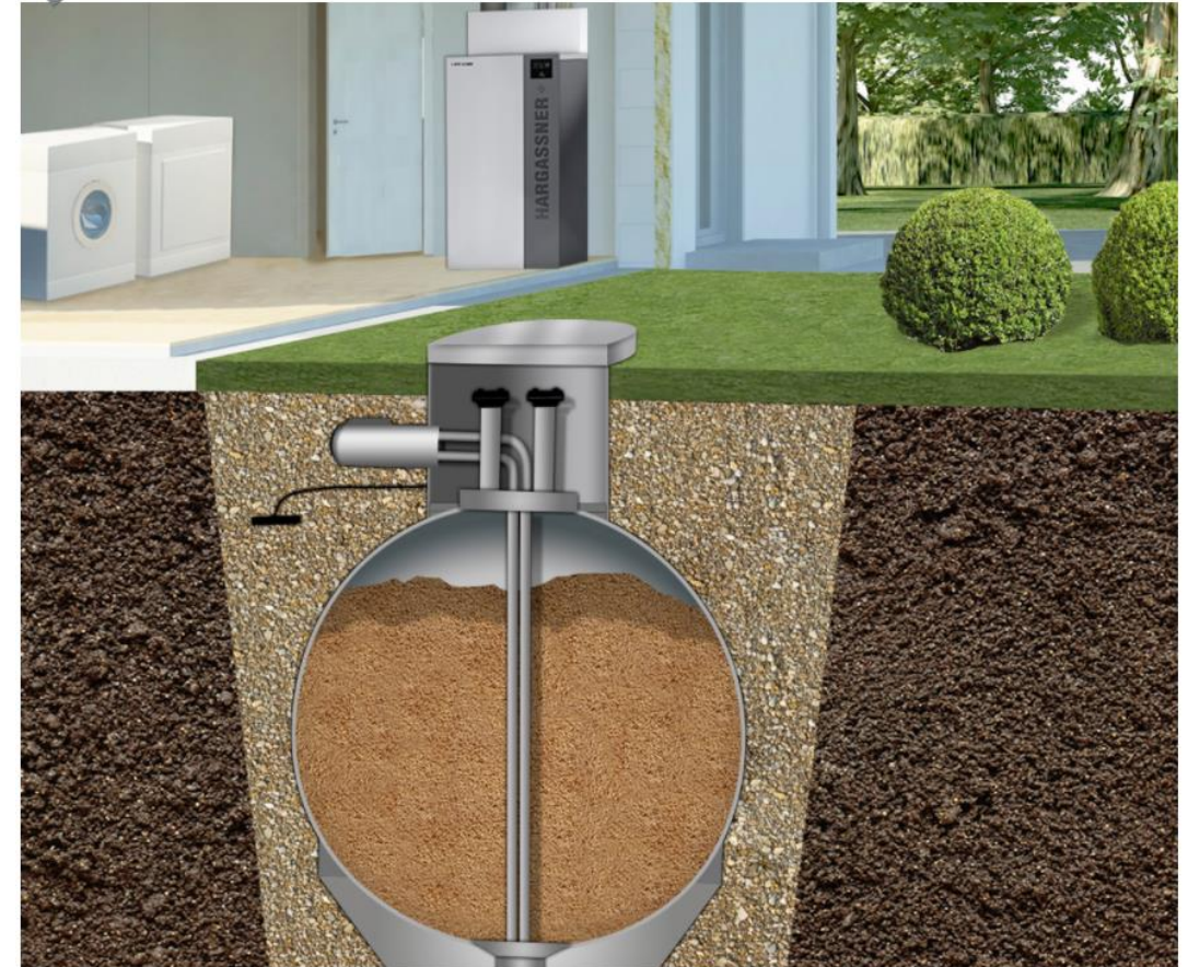
Pellets-Erdtank | Lagersystem für Pelletsheizungen (hargassner.at)
