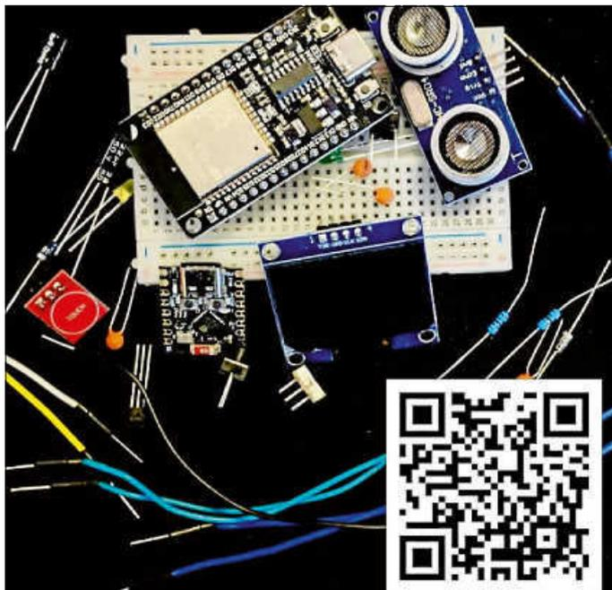
Für die Veranstaltung wurden zehn Hardware-Kits (je zwei ESP32-Microcontroller, Display, Sensoren, Schalter, Kabel, Steckplatine, etc.) vorab günstig beschafft, die zum Selbstkostenpreis überlassen werden. Es besteht auch die Möglichkeit, sich zu zweit anzumelden und ein Hardware-Kit gemeinsam zu nutzen.
